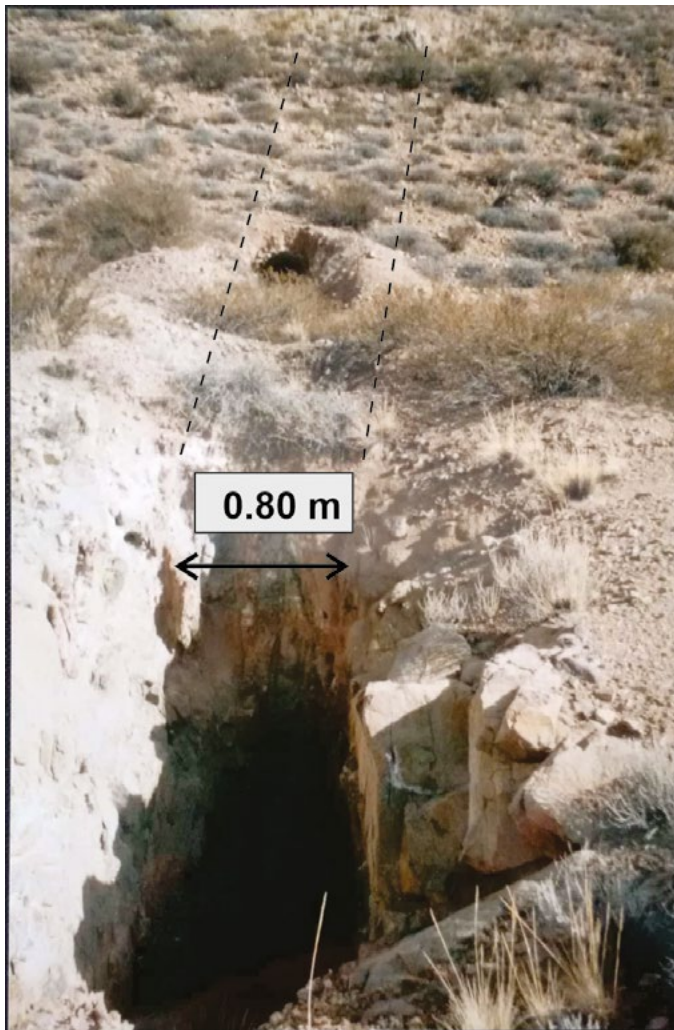
Figura 5. Galerías a cielo abierto sobre veta de dirección E-O en la mina Dos Amigos, en roca encajante granodiorítica (NE del plutón Tocota).
